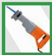
Sierra Sawzall para recortar el exceso de longitud del riel
