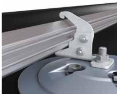
Coloque el riel en los soportes abiertos, colocándolo de modo que la superficie con las ranuras esté en la parte superior y el extremo no sobresalga más de seis (6) pulgadas. Cierre el soporte y apriete los pernos hexagonales de 7/16" a 100 in-lbs. (Si se instala correctamente, no debe haber juego dentro de los soportes cerrados y apretados).
