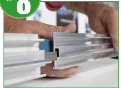
Termine sus secciones deslizando una tira de 2" de ancho del material del techo o la tira de color en las ranuras provistas en la cara del riel Color Snap®, superponiendo la siguiente sección de 7.5'.
